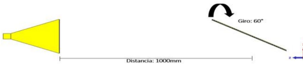
Figura 5: RIS analizada a 30° de inclinación. (Implementación de Superficies Inteligente Reconfigurable (RIS) para realizar experimentos con las comunicaciones inalámbricas Wi-Fi en el rango de 5 GHz aplicadas entornos interiores) [18]
