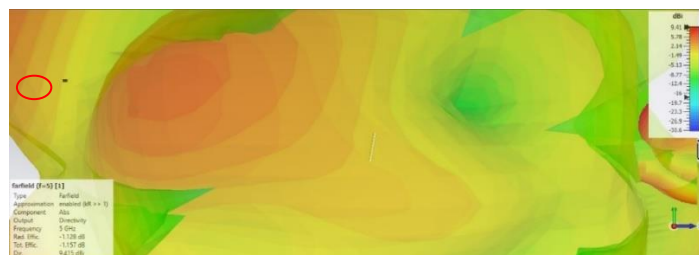
Figura 78: Diagrama de radiación posición 1 a 1 metro con 100° de inclinación. (Autor-CST Studio/Versión Estudiantil)
