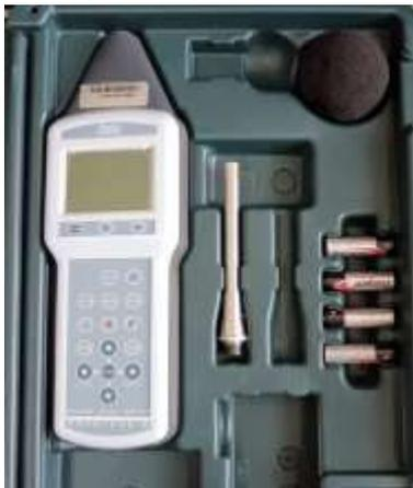
*Nota.* Instrumento utilizado para la medición de sonido
