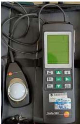
*Nota.* Instrumento utilizado para la medición de iluminación
