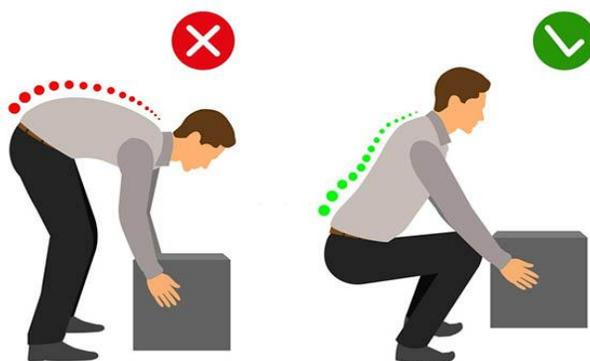
*Nota.* La figura muestra la forma correcta de levantar una carga. Fuente: Sistema de gestión de Seguridad y Salud en el Trabajo, 2018.
