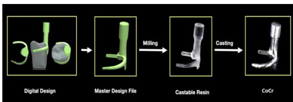
Ilustración 14. Fabricación de ganchos en Cr-Co fresados en CAD.CAM.
