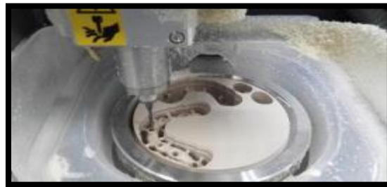
Ilustración 5. Técnica de fresado CAD-CAM.
