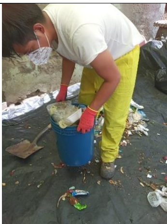
Fotografía 8: Eliminación de vacíos (densidad suelta).
