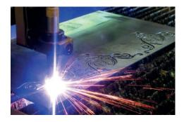
Es un proceso que utiliza gas ionizado a altas velocidades, el cual calienta al material hasta su fundición, y finalmente el gas sopla al metal fundido y lo rompe.
