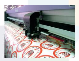
El plotter de impresión está diseñado para imprimir grandes formatos, mediante sus cabezotes los cuales agilitan el proceso. Imprime en diferentes materiales.
