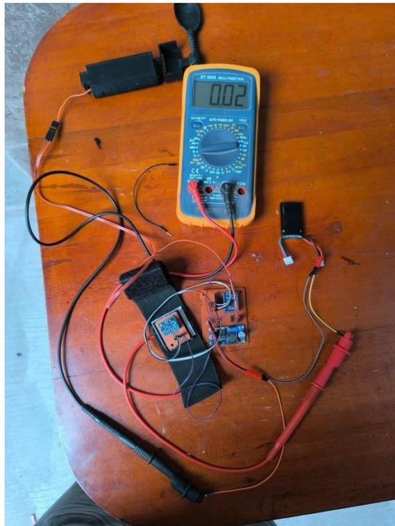
Figura 19 corriente del dispositivo en reposo
