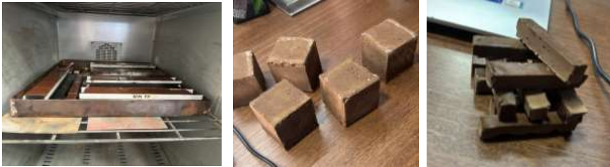
Figura 2. a) Probetas en el horno; b) y c) Probetas desencofradas
