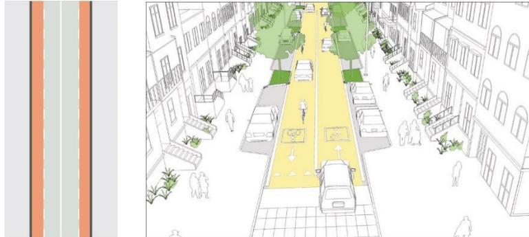
**Figura 2** *Diseño de estrechamiento de carril.*
