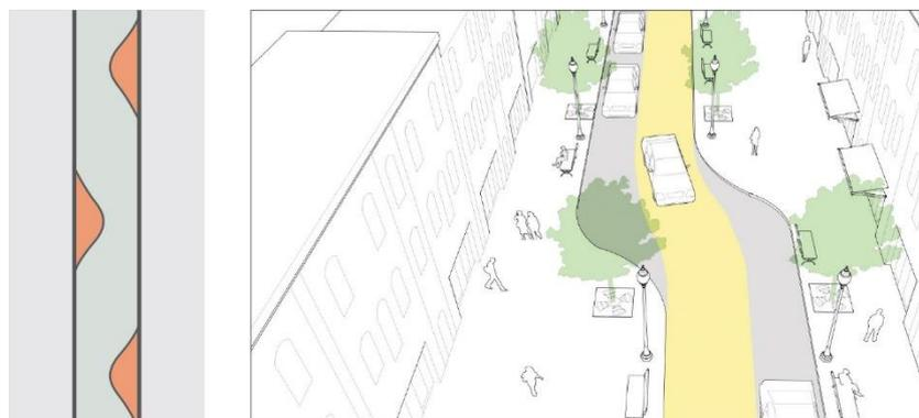
**Figura 6** *Diseño de chicanas y cambios de carril.*
