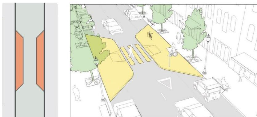
**Figura 5** *Diseño de puntos de aprisionamiento.*
