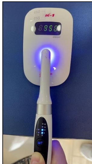
Figura 1. Calibración de la lámpara de fotocurado.
