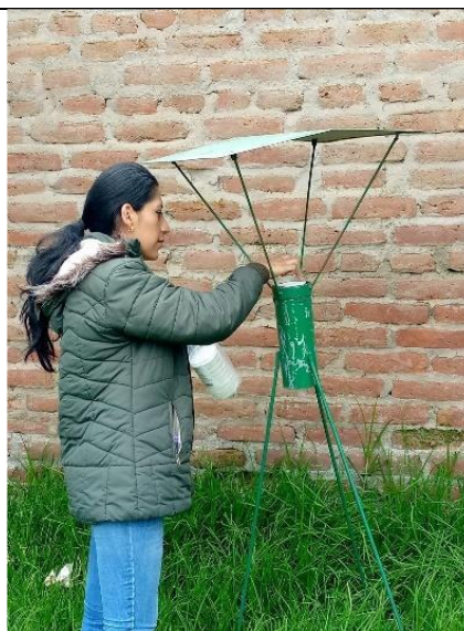
Fotografía 4. Instalación de estaciones de material particulado sedimentable.
