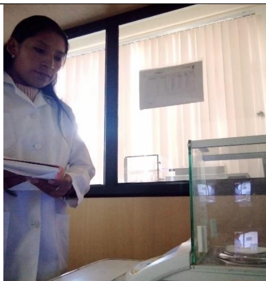
Fotografía 3. Pesaje del papel filtro que se colocará en los equipos de material particulado sedimentable.
