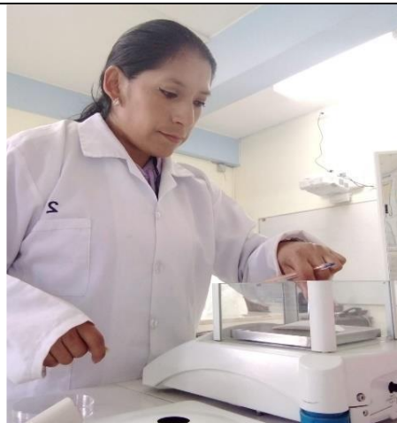
Fotografía 2. Pesaje del papel filtro que se colocará en los equipos de material particulado sedimentable.
