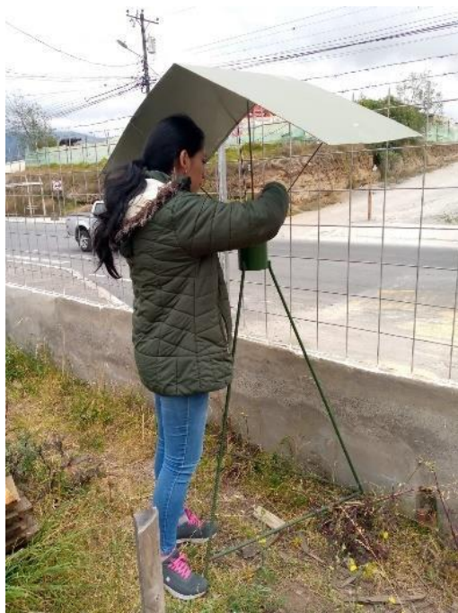
Fotografía 5. Instalación de estaciones de material particulado sedimentable
