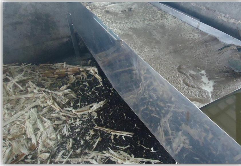
**FIGURA N° 7** Tanque de sedimentación de jugo de caña.
