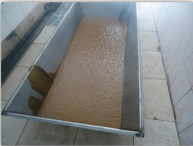
**FIGURA N° 11** Tanque de Batido y granulado de la panela.
