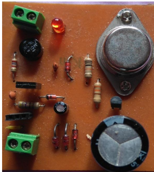
Figura 2. 7 Fuente de voltaje armada Fuente: Autor
