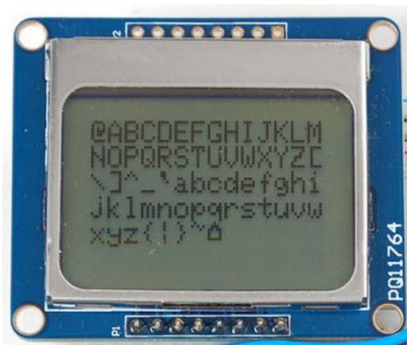
Figura 1. 12 Nokia 5110 Módulo LCD 84X48 con retroiluminación
