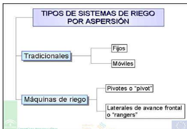
Imagen 5. Tipos de sistemas de riego por aspersión. Fuente: www.elriego.com
