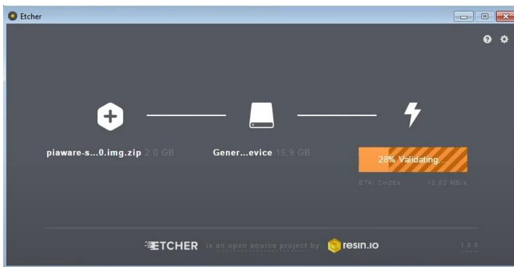
Ilustración 20. Instalación del sistema operativo PiAware.
