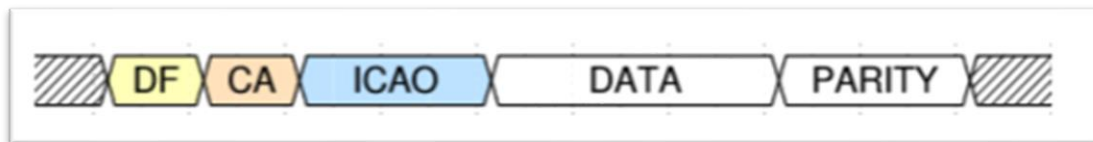
Ilustración 4. Estructura del mensaje ADS-B
