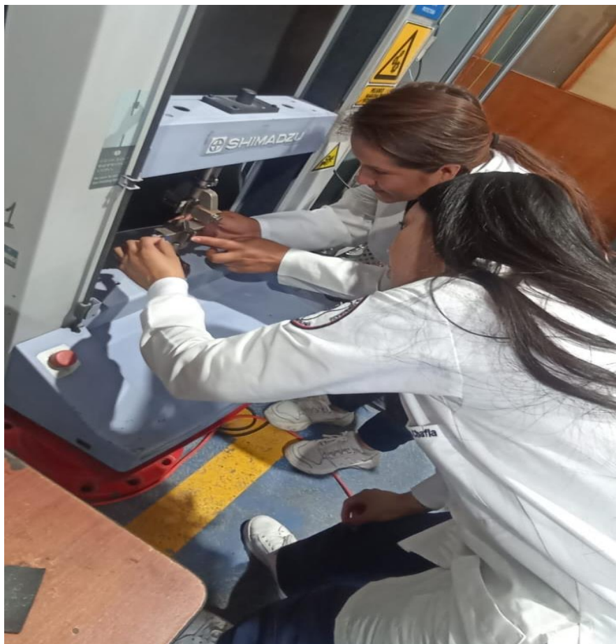
Colocación de la muestra en la máquina de ensayos universal.
