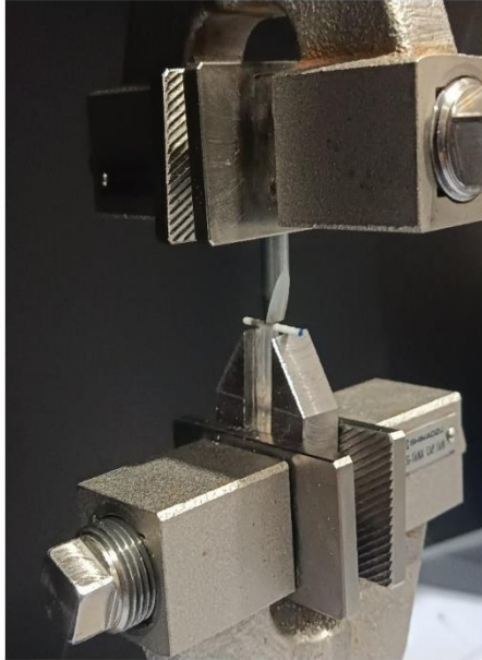
Fotografía 3. Montaje muestras grupo Reforpost Angelus para ensayo de flexión.
