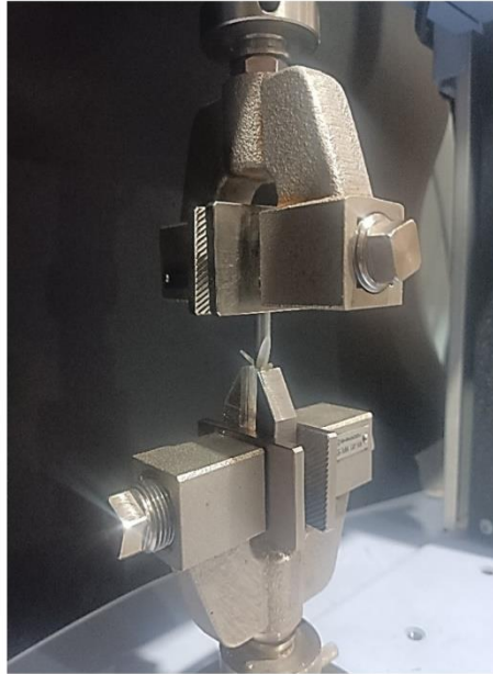
Fotografía 1. Montaje muestras grupo AAA Fiberpost para ensayo de flexión.
