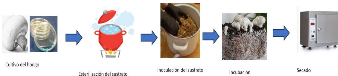
Figura 2. Fases de elaboración de materiales a base de micelio. Adaptado de: (Manana et al., 2021) y (Jones et al., 2020a)
