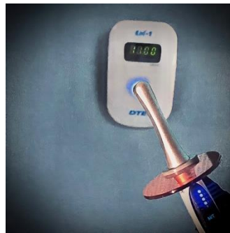
Fotografía 6: Calibrando la lámpara de fotocurado, resultando 1100 mW/cm 2
