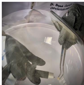
Fotografía 12: Arenado de cada muestra
