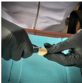
Fotografía 3: Corte de la cerámica con disco de diamante
