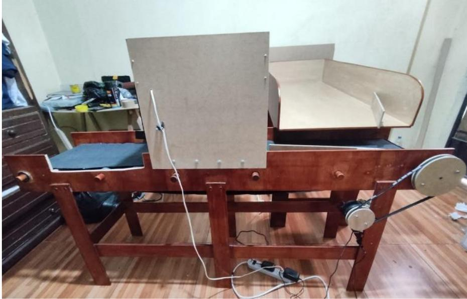
Figura 18. Mesa vibratoria y banda transportadora del prototipo.
