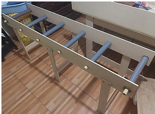
Figura 10. Base de la banda transportadora con los rodillos instalados.
