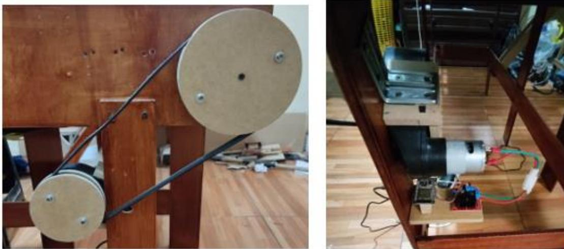
Figura 15. Poleas (izquierda) y Motor acoplado (Derecha).
