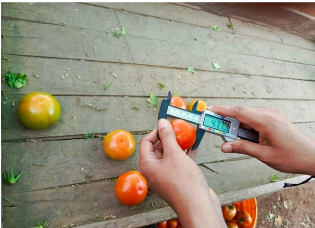
Anexo 7 – Clasificación manual por tamaños de tomates riñón usando un calibrador digital
