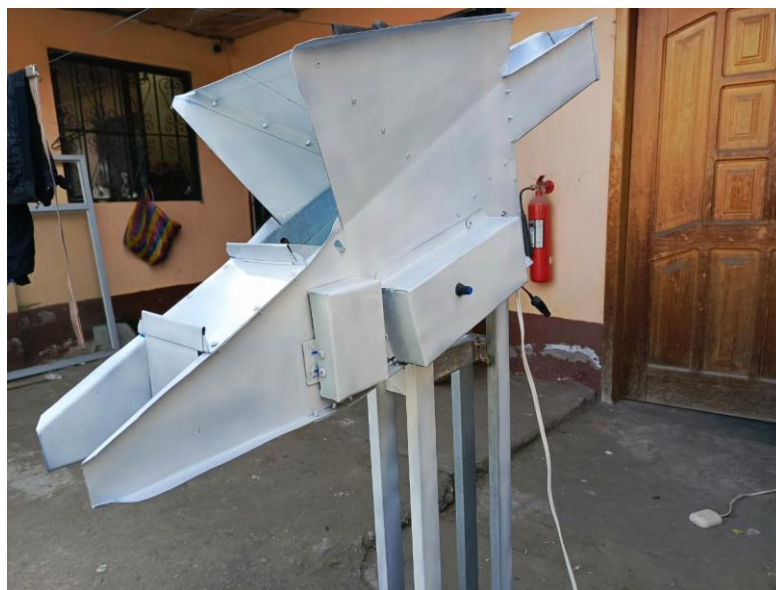
Figura 22: Tolva de distribución de tomates.
