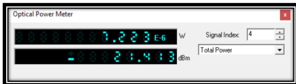
**Figura 40: Potencia de llegada a la OLT del usuario cercano a 1.635 Km enlace upstream**
