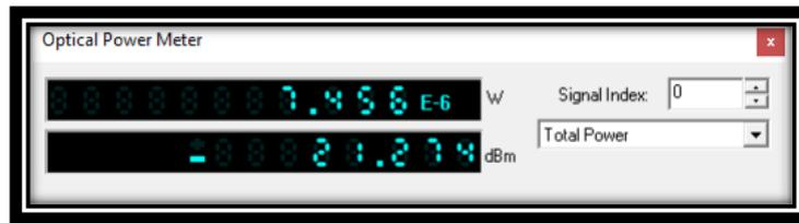
**Figura 38: Potencia final recibida en el equipo ONU usuario lejano a 2.063 Km downstream**
