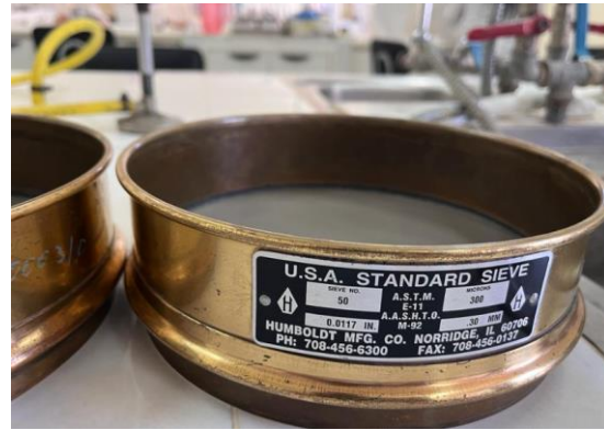
Fotografía 6. Tamices para obtener el tamaño de partícula deseado
