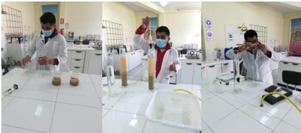
*Ilustración 57 Ensayo de Granulometria via Hidrómetro*
