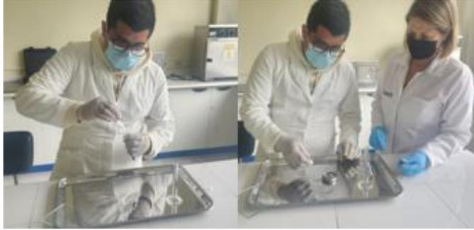
*Ilustración 10 Ensayo de Límite de Contracción*
