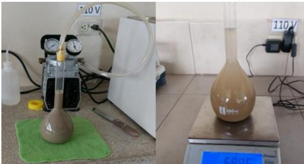
*Ilustración 18* Ensayo de Gravedad Específica
