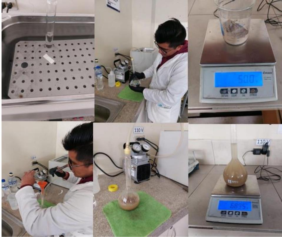
*Ilustración 56 Ensayo de Gravedad Especifica*
