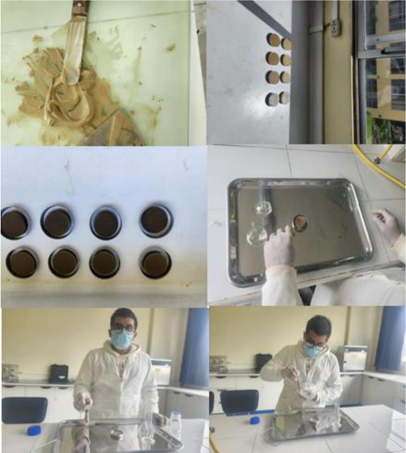
*Ilustración 58 Ensayo de Límite de Contracción*
