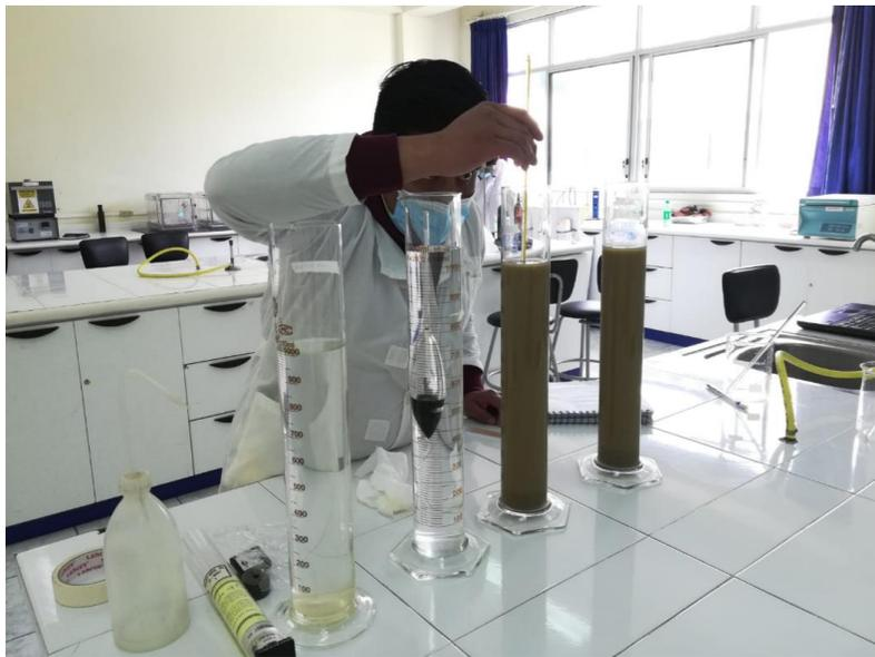
*Ilustración 19 Ensayo de Granulometría por Hidrómetro*
