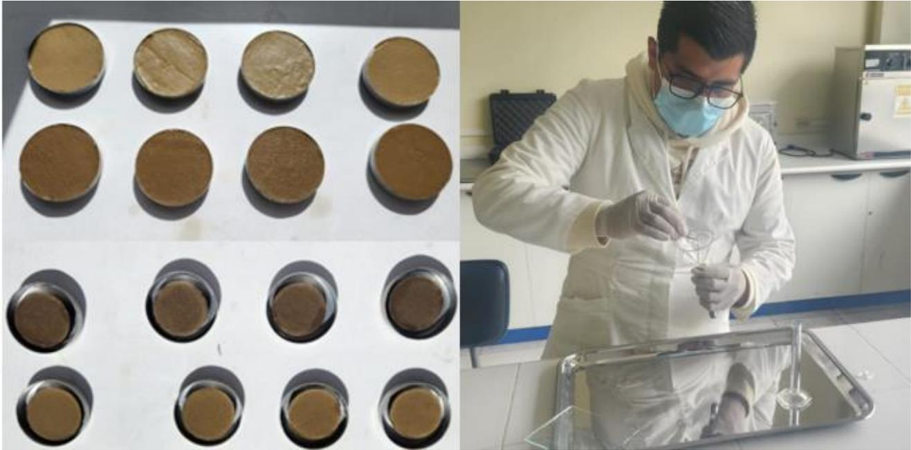
*Ilustración 20 Ensayo de Límite de Contracción*
