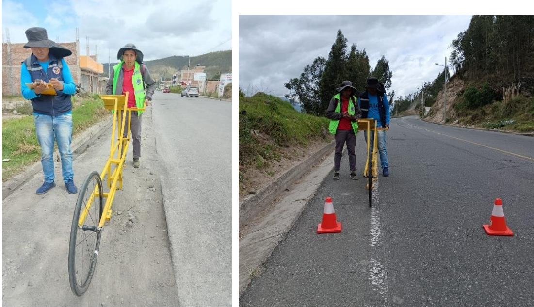
Foto 3. Ensayo de rugosidad en el tramo vial Cacha - Yaruquíes
