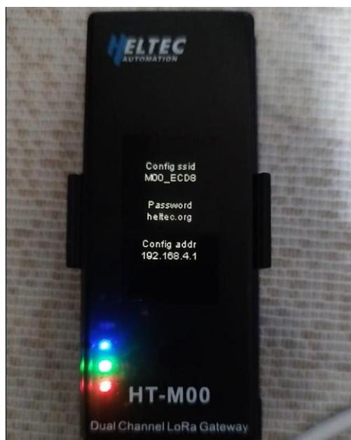
**Figura 23:** Datos para autenticación del Gateway HT-M00. **Fuente:** Autor.
