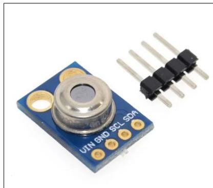
*Figura 7: Sensor Infrarrojo de Temperatura LMX90614 [31].*
