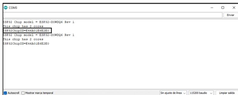
Figura 38: ChipID del Módulo Wifi LoRa 32 v2. Fuente: Autor
