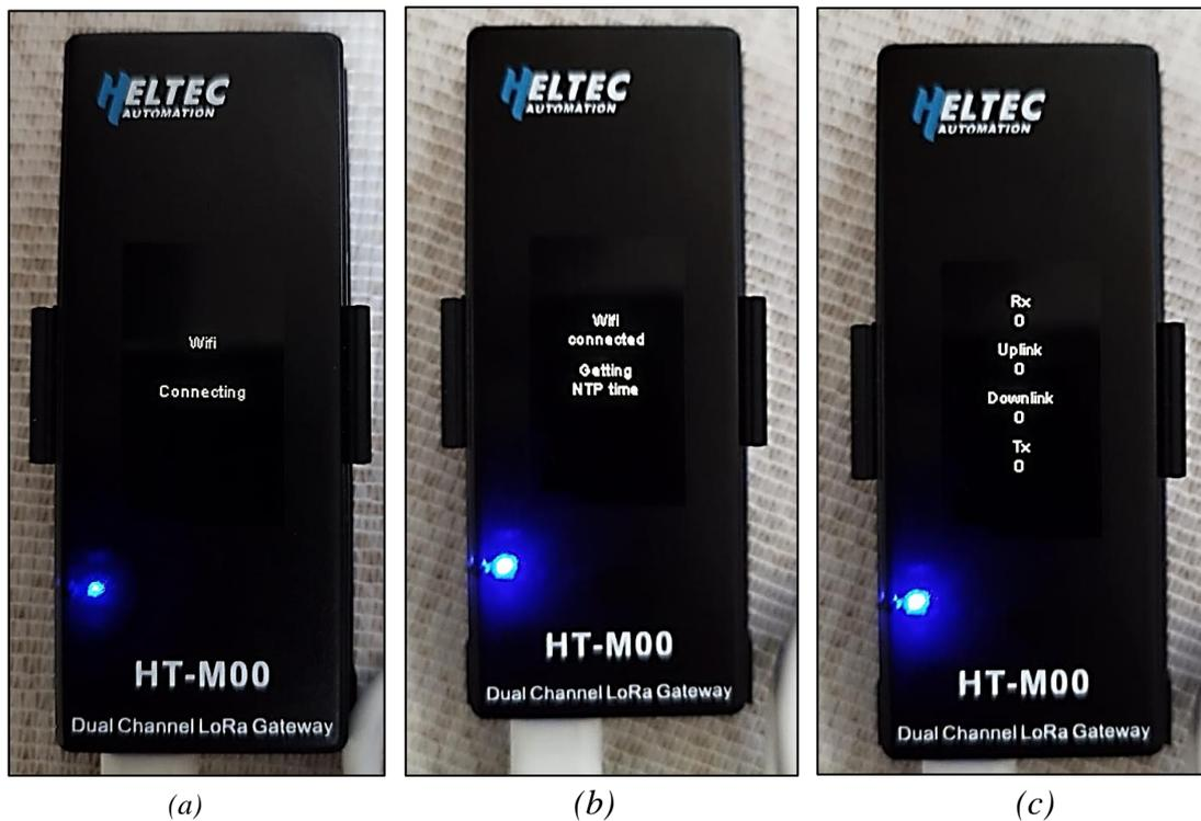
**Figura 25:** (a) Gateway HT-M00 conectándose al wifi (b) Gateway HT-M00 conectado al wifi (c) Gateway HT-M00 entregando información de Recepción y Envío de Datos. **Fuente:** Autor.
