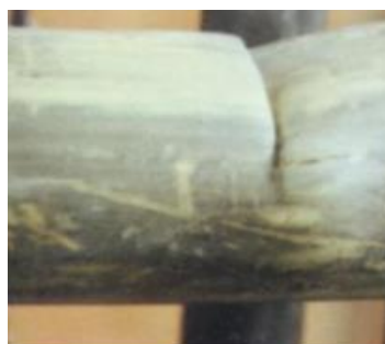
Ilustración 4 Falla a compresión Fuente: (NEC-SE-GUADÚA, 2016).
