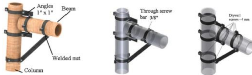
Ilustración 10 Junta de abrazadera de acero de Moran.
