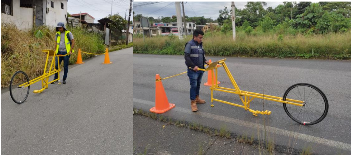
Foto 4 Ensayo de regularidad en la Av. Muyuna de la ruta 2
