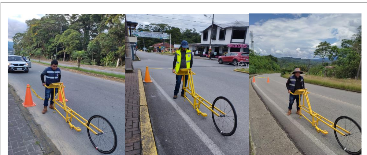
Foto 1 Ensayo de regularidad en la C. Teniente Hugo Ortiz de la ruta 1
