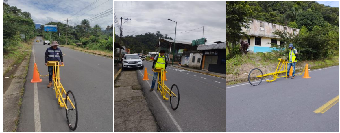
Foto 3 Ensayo de regularidad en la Av. Pano de la ruta 2
