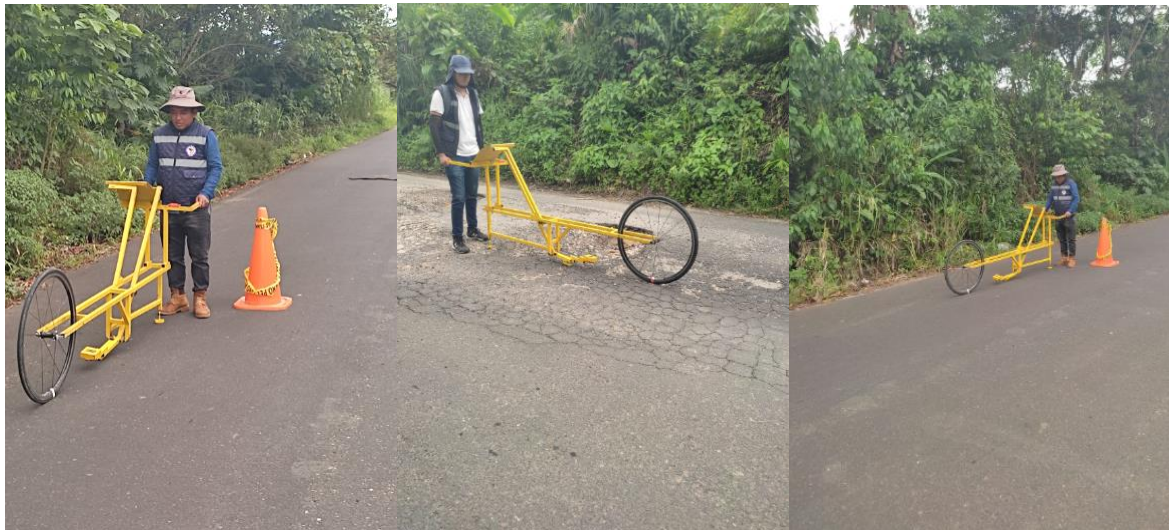
Foto 5 Ensayo de regularidad en la vía Sexta Transversal de la ruta 3
