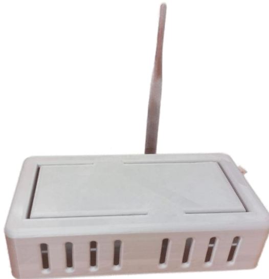
Figura 4.11 Dispositivo final gateway
