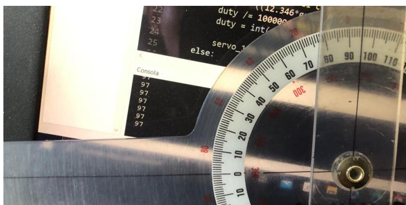
Figura 24 Comparación entre el ángulo medido por el sensor y goniómetro, del autor.
