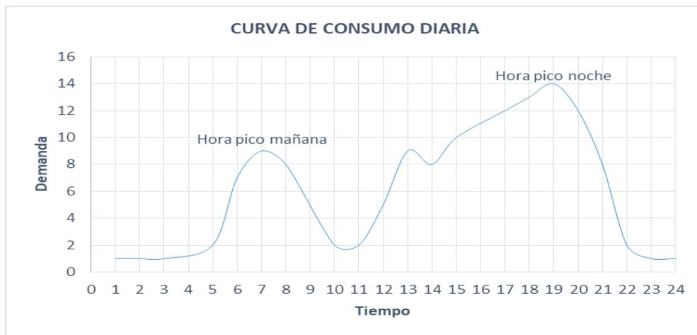
**Figura 3.** Curva de consumo horario máximo de una red de distribución de agua potable
