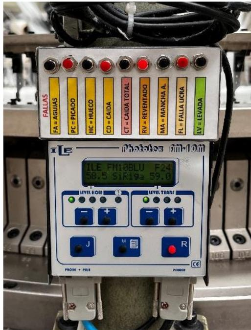
**Figura 29:** Selector de tipos de fallos por scanner.
