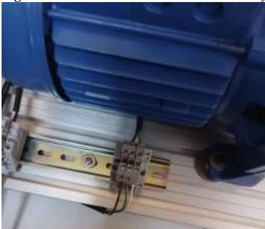
Figura 12 Conexión directa de la bomba centrífuga y la toma de corriente de 220 v
