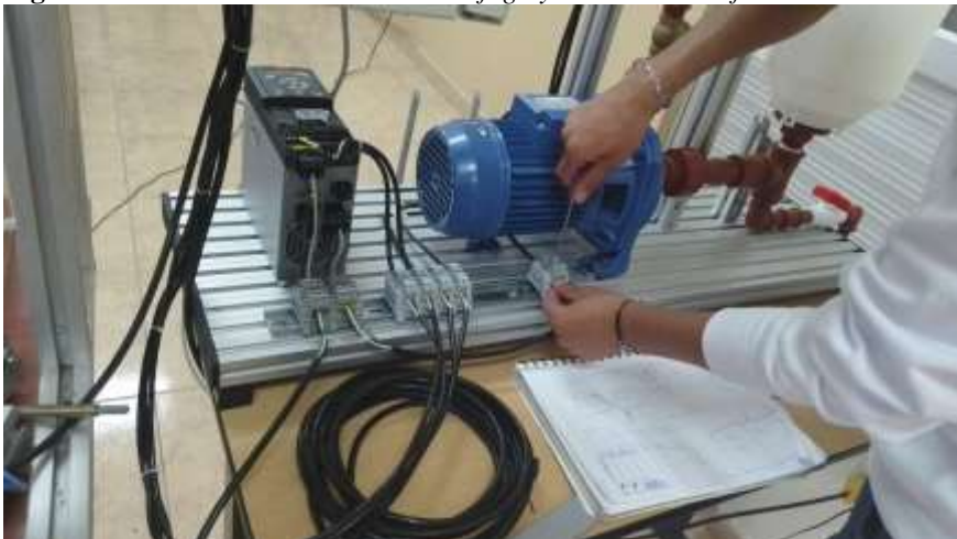
Figura 14 Conexión de la bomba centrífuga y el variador de frecuencia
