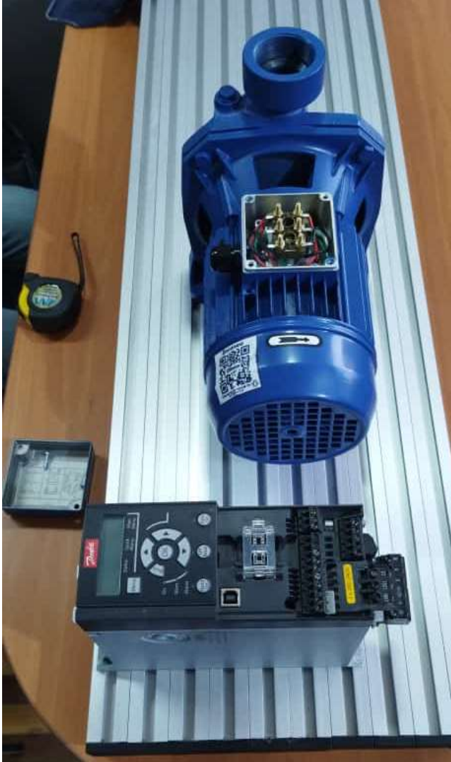
Figura 9 Montaje de la bomba trifásica y el variador de frecuencia.
