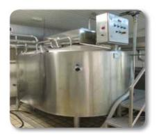
**Descripción:** En la olla se va a realizar el tratamiento térmico de la leche (en el caso de realizar pasteurización baja o lenta), gran parte de la fermentación de las bacterias lácticas, coagulación, corte, agitación, recalentamiento y desuerado.
