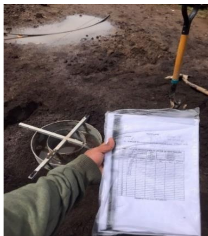
Figura 7. Recolección de datos, velocidades de infiltración
