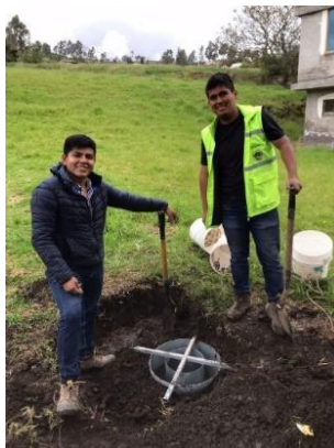
Figura 4. Colocación de infiltrómetro en la gaveta de excavación
