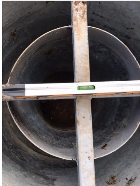
Figura 6. Comprobación de nivel y profundidad, anillo doble
