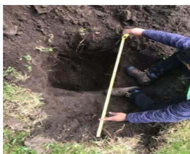
Figura 5. Comprobación de medidas de calicatas
