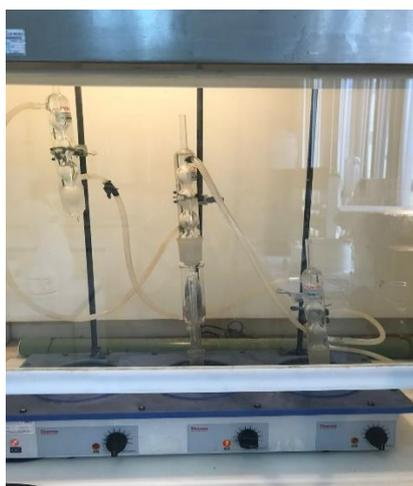
*Ilustración 9 Extracción de aceite por el método Soxhlet*
