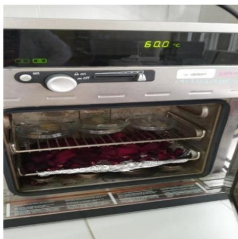
*Ilustración 6 Secado en la estufa*
