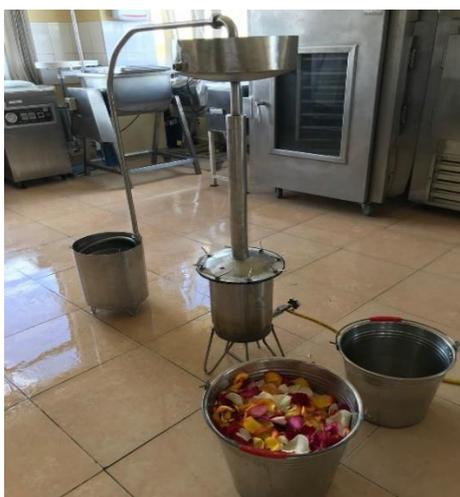
*Ilustración 3 Extracción de aceite por arrastre de vapor*
