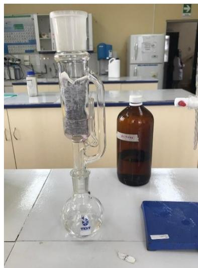
*Ilustración 8 Armado del aparato de Soxhlet*
