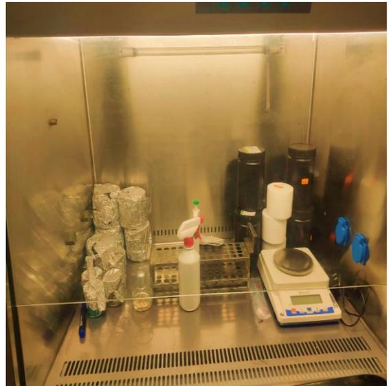
*Ilustración 21. Cabina de flujo laminar*
